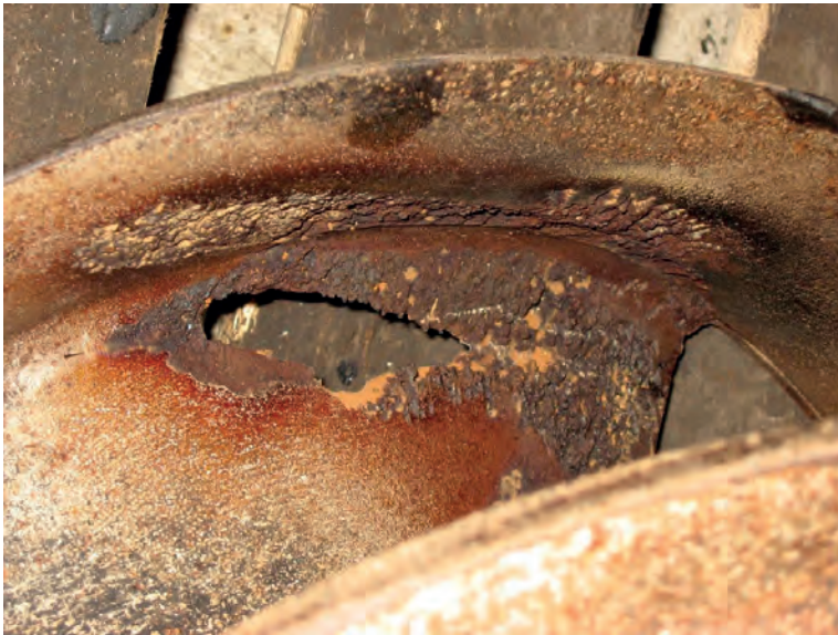
FOT. 1 Uszkodzenia kawitacyjne wirnika pompy zasilającej do ścieków oczyszczonych po niespełna roku pracy; materiał wirnika – żeliwo sferoidalne EN-JS 1050
