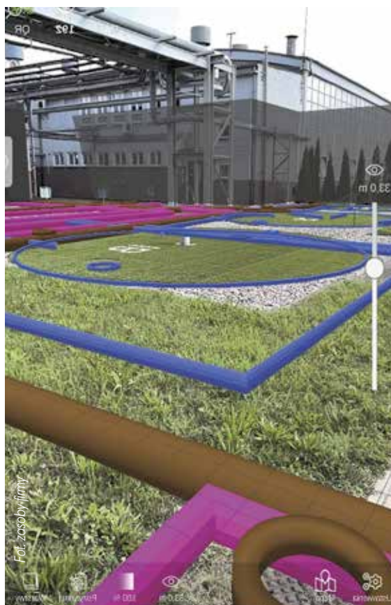
WIZUALIZACJA instalacji podziemnych technologią AR
