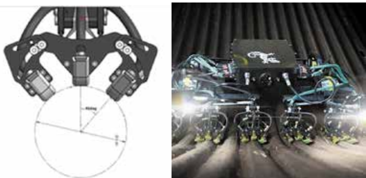
FOT. 1 Robot wykonuje pomiary ultradźwiękowe z rozdzielczością co 6 mm na linii prostej
