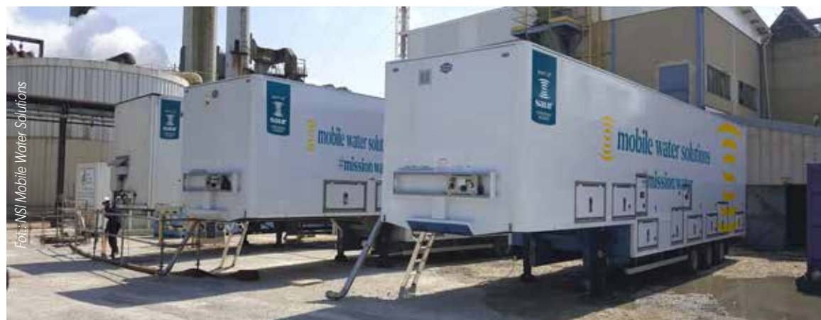
INSTALACJA MOBILNA składa się z dwóch lub trzech mobilnych jednostek, które można podłączyć w bardzo krótkim czasie
