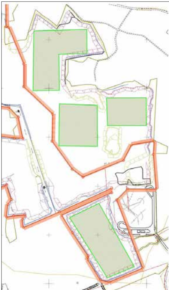
RYS. 3 Nieregularna linia brzegowa akwenu poeksploatacyjnego
