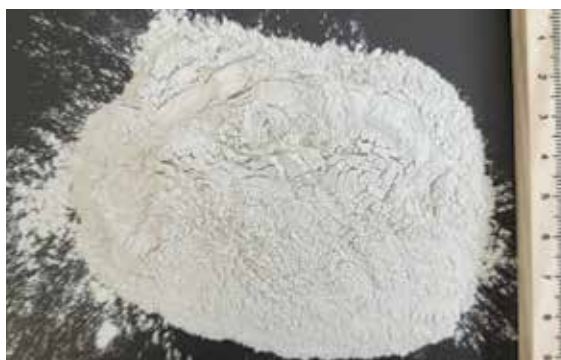
FOT. 1 Pył zeolitowy do aglomeracji ciśnieniowej dwustopniowej
