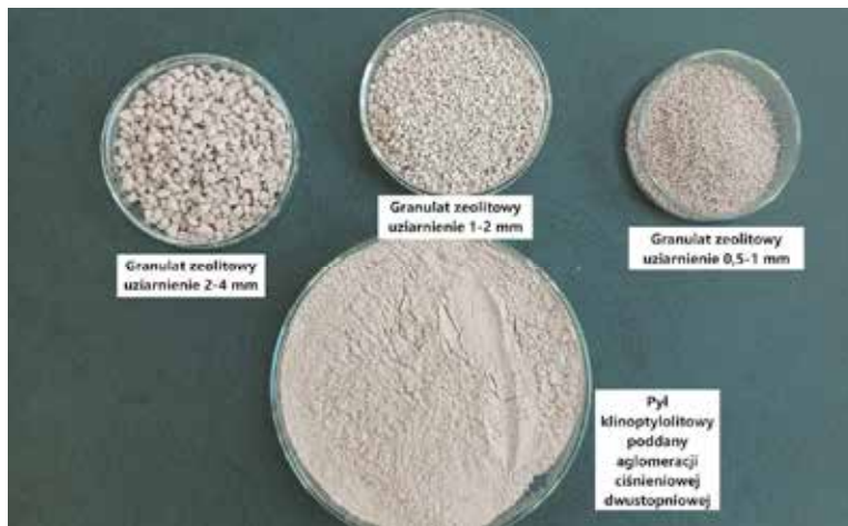
FOT. 5 Produkt aglomeracji ciśnieniowej dwustopniowej pyłu zeolitowego
