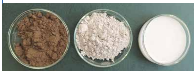
FOT. 4 Lepiszczka zastosowane do aglomeracji ciśnieniowej dwustopniowej pyłu zeolitowego. Od lewej: cement glinowy, żużel wielkopiecowy, środek hydrofobowy
