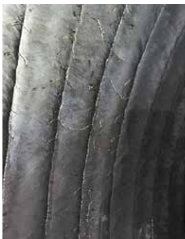
FOT. 2 Zdjęcia nieciągłości plateru wymiennika
